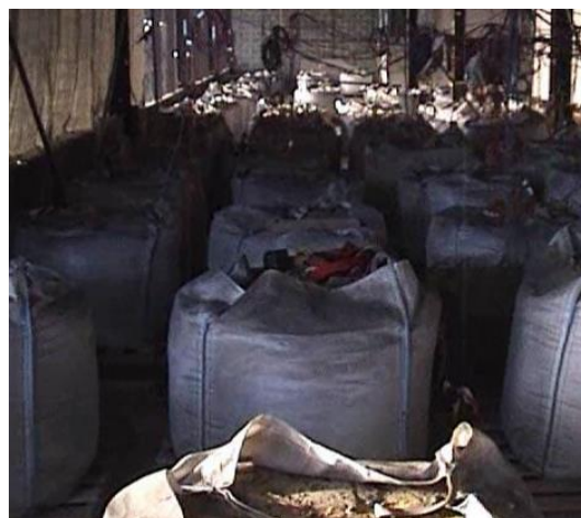
Figura 2.19 - Simulação das cargas através de sacos de areia.
