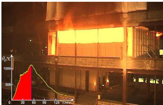
Figura 2.22 - Fase de aquecimento durou aproximadamente 50 min.
