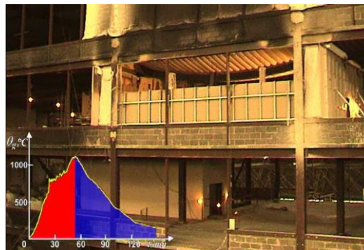
Figura 2.23 - A fase de aquecimento e arrefecimento durou cerca de 130 min.
