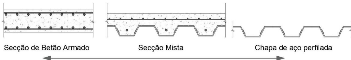
Figura 1.1 - Esquema representativo da abrangência do conceito de estrutura mista.
