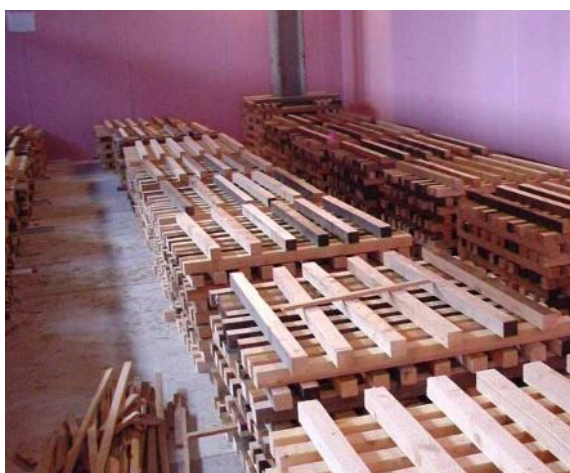
Figura 2.20 - Simulação da carga de incêndio através de paletes de madeira.
